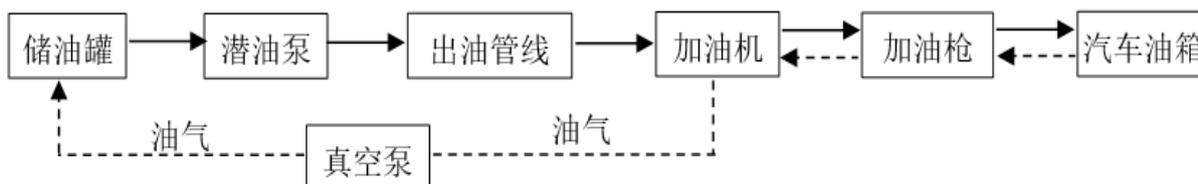
图 2-5 汽油加油工艺流程示意图
