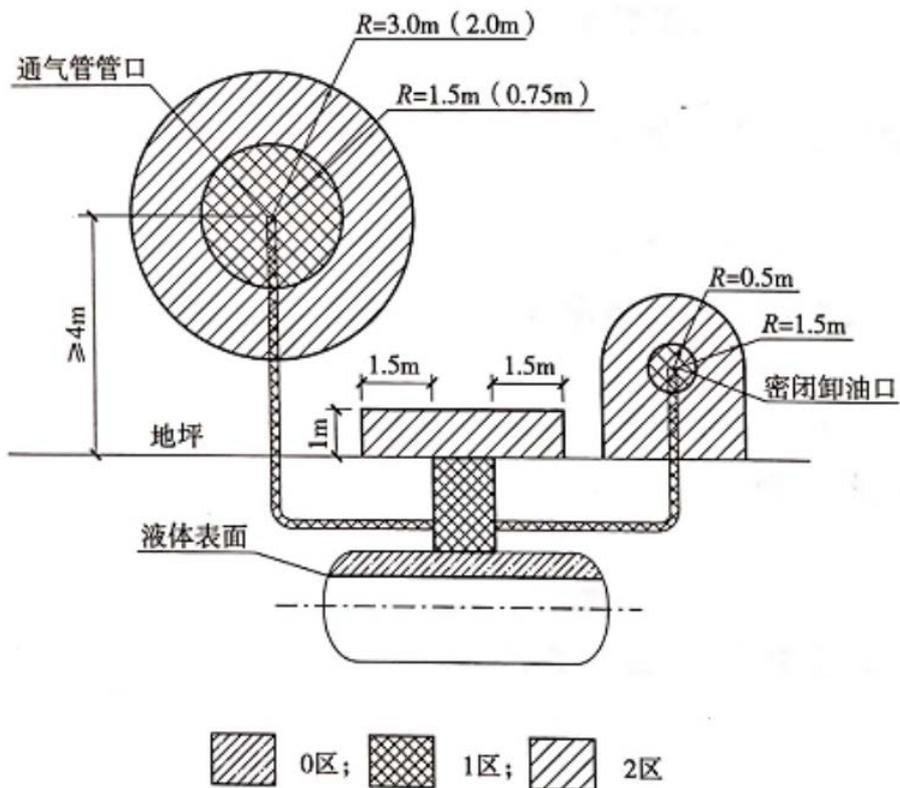
图 3-3 埋地卧式汽油储罐爆炸危险区域
