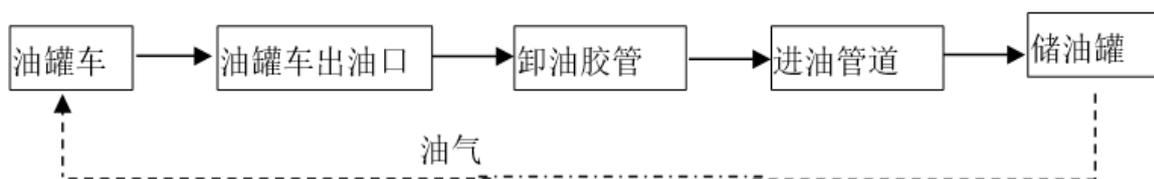
图 2-4 汽油卸油工艺流程图
